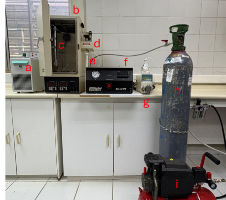
Figura 3. Sistema de Extracción Supercrítica. (a) Enfriador, (b) Horno, (c) Recipiente de extracción, (d) Válvula reguladora de salida, (e) Vial recolector, (f) Bomba de alta presión, (g) Bomba inyectora de cosolvente, (h) Tanque de CO 2 (i) Compresor de aire.
